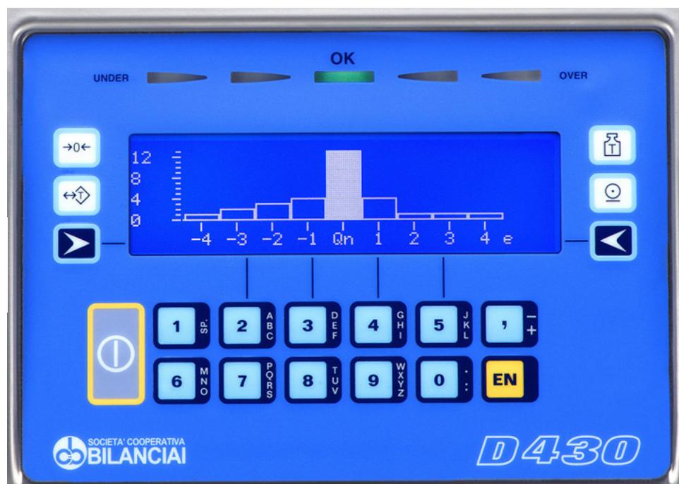
D 430 Display-Anzeige mit Balkengrafik
