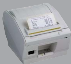
Externer Etikettendrucker mit Etikettenspender
